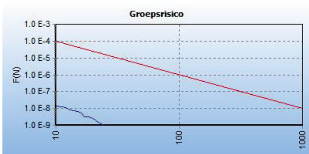
Figuur 6 FN-curve van de kilometer met de hoogste overschrijdingsfactor van gastransportleiding W-535-11 in de huidige situatie. De ligging van deze kilometer is hiernaast in het rood weergegeven op een topografische kaart.
